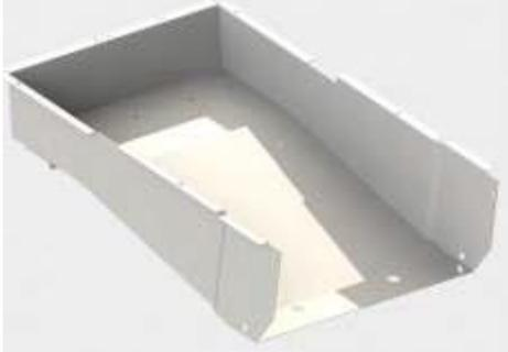
**Conjunto Tampa mais rampa** - Tampa estrutural em aço carbono 1,5 mm Rampa de Alumínio 3,00 mm com acabamento em pintura preta, piso vinílico e fitas antiderrapante.
