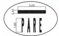
DETALHE LINHA DE RETENÇÃO
