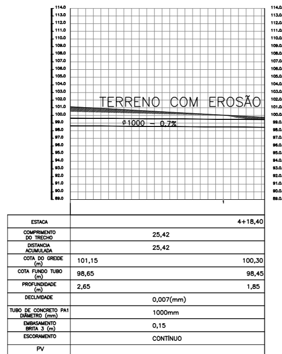
PERFIL LONGITUDINAL – TRECHO 03
